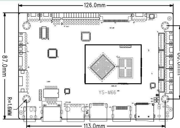
\*PCBA 长度: 126mm \*PCBA 宽度: 87mm \*PCBA 高度: 12mm \*PCBA 螺丝孔径: 3.2mm x4
