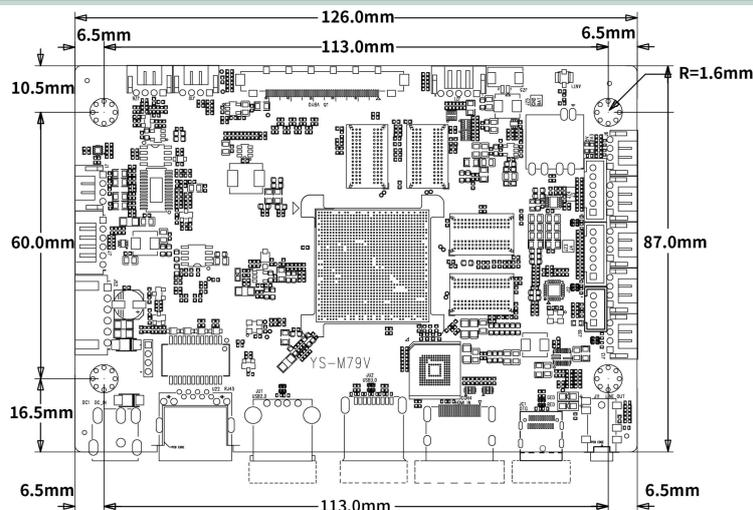
\*PCBA 长度：126mm \*PCBA 宽度：87mm \*PCBA 高度：12mm \*PCBA 螺丝孔径：3.2mm x4
